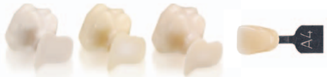
Abb. 5: Vergleich der Farbübereinstimmung eines mit A4 eingefärbten dreigliedrigen Brückengerüsts, das am Verbinderschnitt durchgeschnitten wurde. Von links nach rechts: Wettbewerber 1, Wettbewerber 2, Lava™ Plus Zirkoniumoxid, VITA Classical-Farbring.
